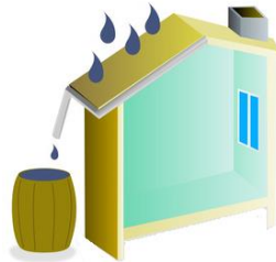
le récupérateur d'eau de pluie
